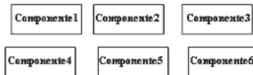
Per usare il `LayoutManager FlowLayout` nell'esempio precedente basta invocare il metodo `setLayout` con parametro `new FlowLayout()`, e poi i componenti vengono automaticamente inseriti dalla `add` da destra verso sinistra sulla stessa linea.
