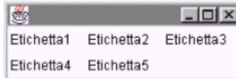
Il LayoutManager CardLayout permette di visualizzare componenti diversi in tempi diversi, ovvero esso visualizza solo un componente alla volta, ma il componente visualizzato può essere cambiato. Ecco un esempio dell'uso di CardLayout
