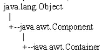
Un *Container* è un contenitore per oggetti GUI, e quindi anche per altri container. Esso se usato insieme ad un *Layout Manager* permette di contenere anche più di un GUI (e Contenitori), permettendo di fare apparire più oggetti nelle nostre interfacce. Vediamo cosa contiene la classe.
